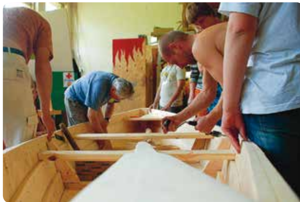
Meistaru Jāņa Apsiša un Kārļa Rokpeļņa vadībā ēvelējot, urbjot un naglojot, top koka plakandibena laiva – tāda, kādas būvēja vectēvi
